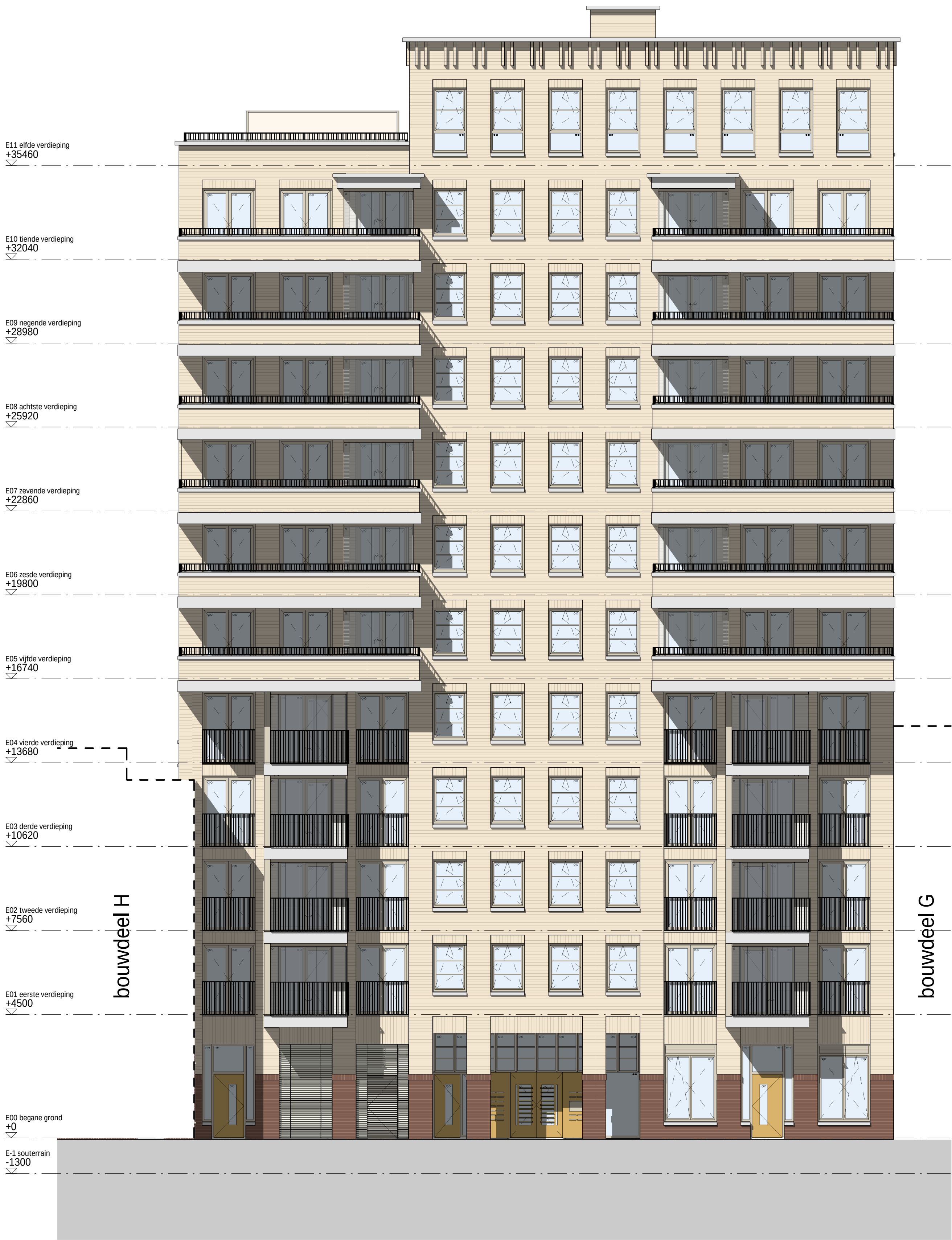
aanzicht 1 - voorgevel schaal 1 : 100
