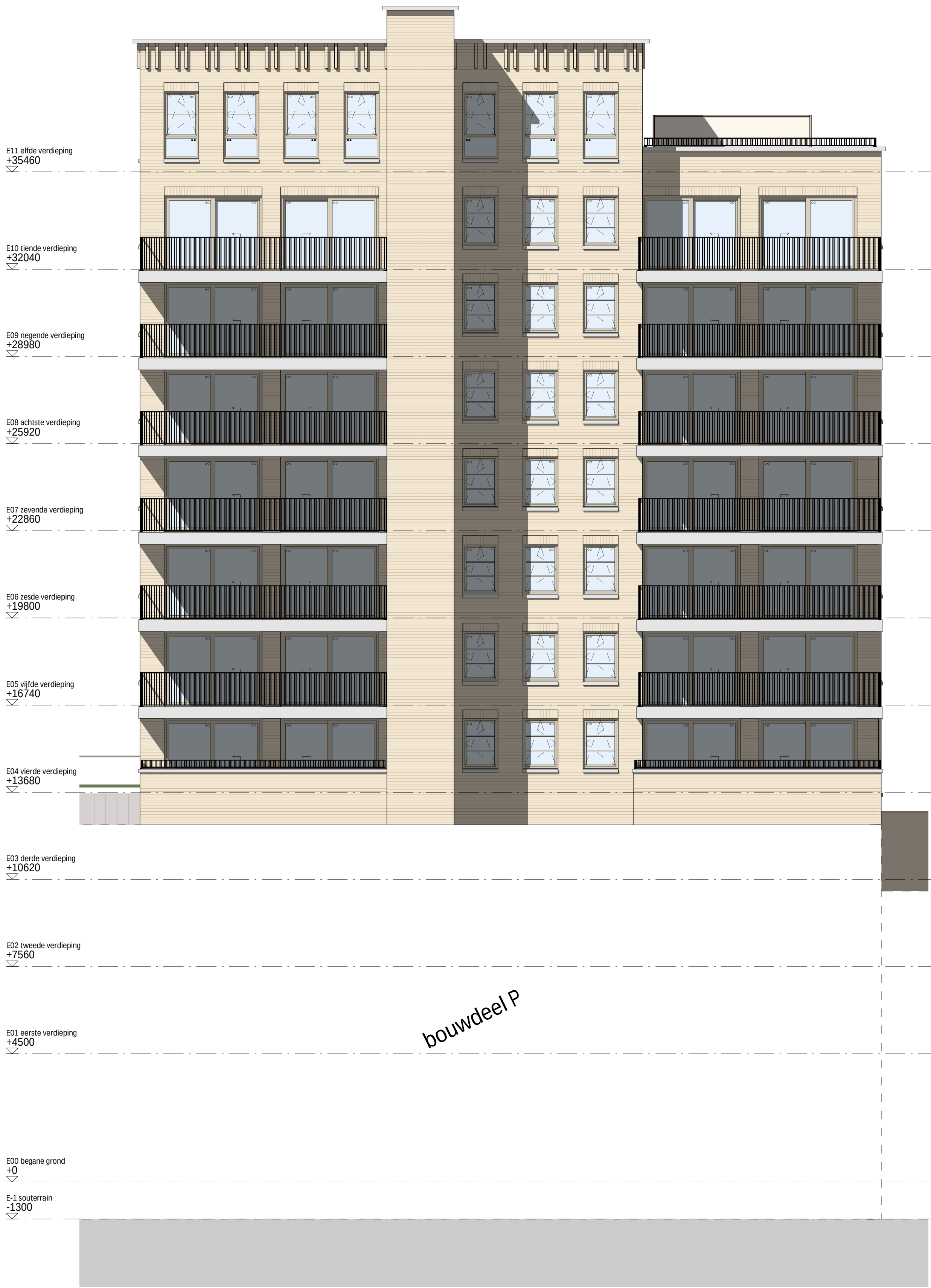
aanzicht 3 - achtergevel schaal 1 : 100
